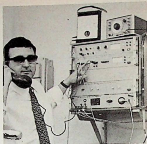
Rechts afb. 6. Afregelen van de apparatuur van een meetstation. Van boven naar beneden: impuls-intensiteitsmeter, niveau/frequentie-omzetter, ijsignaal-ontvanger en netvoeding.
